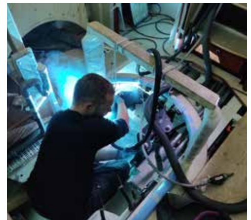
links en rechts: Plaatsing van de elektromotor op een nieuwe fundatie onder de vloer bij de kajuitingang
