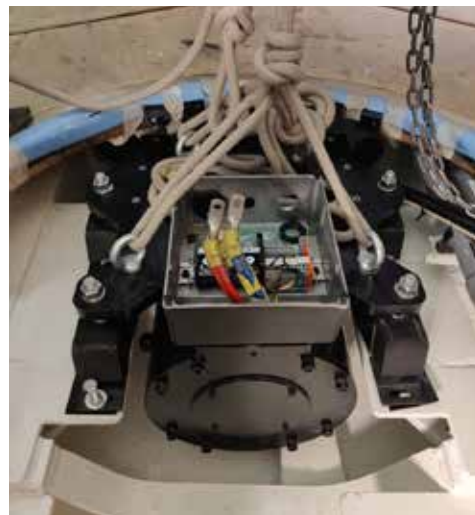
links en rechts: Plaatsing van de elektromotor op een nieuwe fundatie onder de vloer bij de kajuitingang
